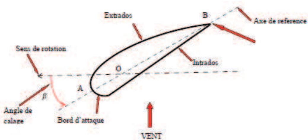
Figure I.15: Eléments caractéristiques d'une pale
