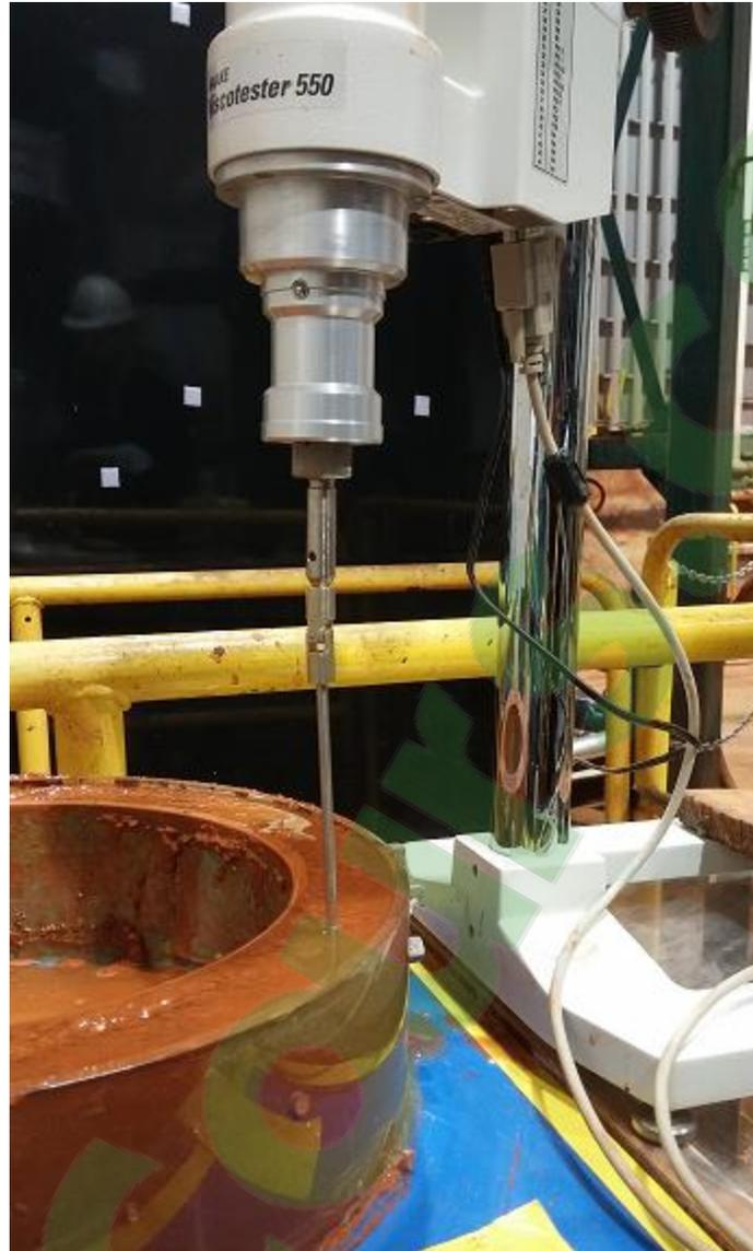
Figure 79. Prise de la viscosité et du seuil de cisaillement
