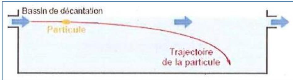
Figure 9. Décanteur horizontal standard [31]
