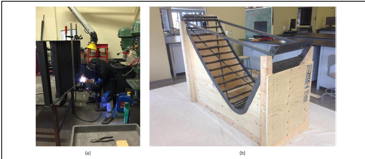
Figure 6.8 Structure en acier des modèles mâles de la dérive portante; (a) Soudage;
