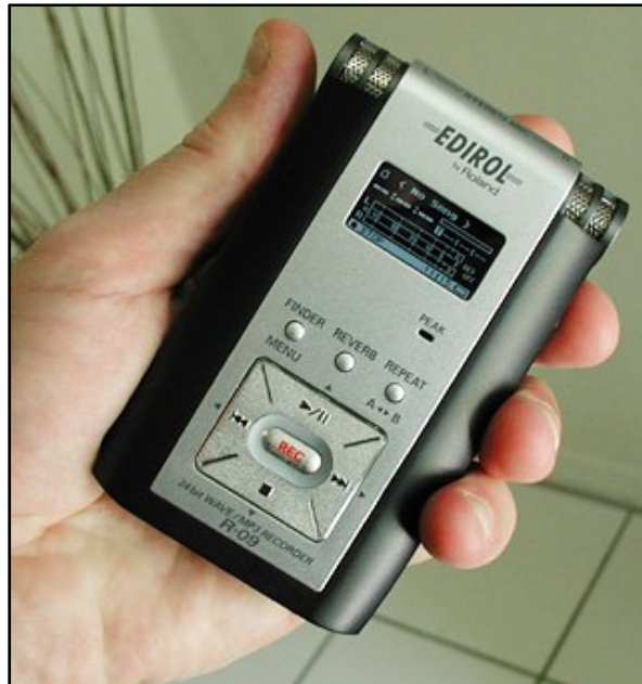
Figure 2.7 : Photo de face de l'enregistreur Edirol R-09 utilisé pour les mesures terrains
