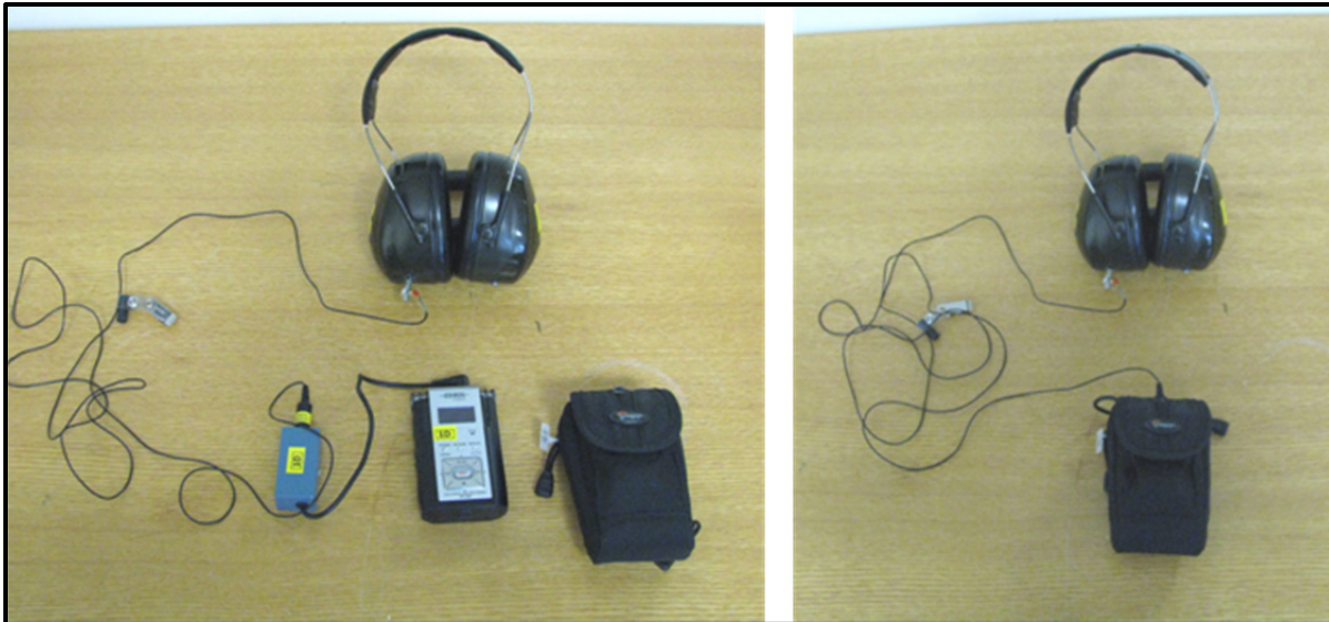
Figure 2.11 : Aperçu du système de mesure complet connecté à la coquille droite d'un serre-tête (l'image de droite montre le système complet tel que pouvant être installé à la ceinture d'un travailleur)
