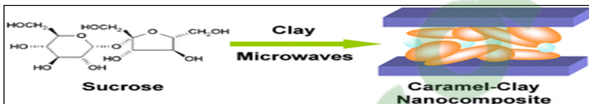
Figure 1.7 La méthode de la microonde pour la préparation d'une argile caramélisée Tirée de Darder et Ruiz-Hitzky (2005)
