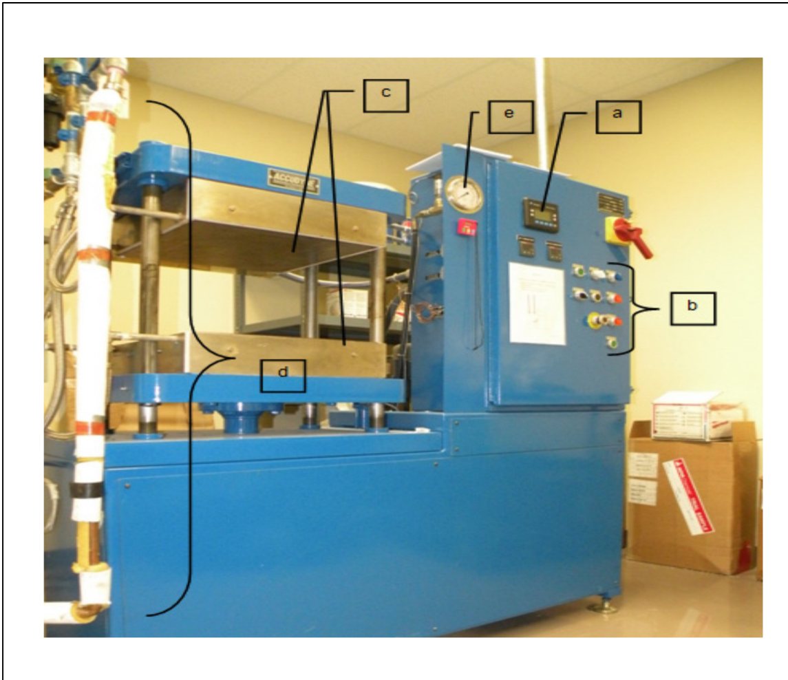
Figure 2.15 Presse chauffante hydraulique dix tonnes à contrôleur de température. a) contrôleur de température, b) Commande de la presse, c) plaques chauffantes, d) circuit de refroidissement et e) jauge de pression Tirée de Zazoum (2014)
