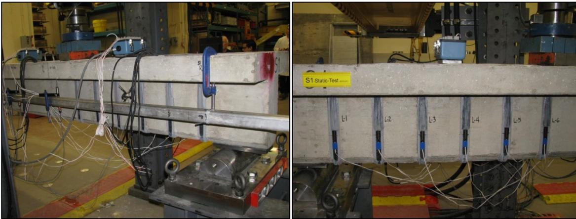
Figure 3. 9 Poutre instrumentée sur le banc d'essai
