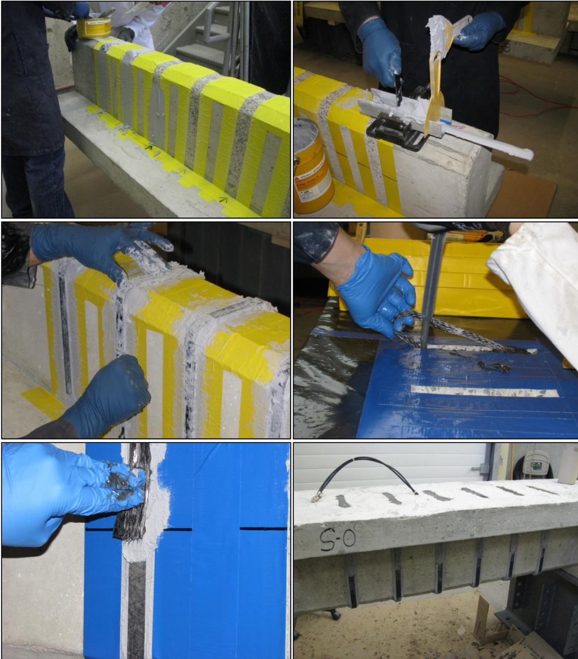
Figure 3. 7 Collage du système de renforcement externe
