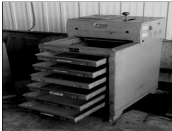
Figure 3-5 : Appareil Gilson Testing Screen, modèle TS-1 pour le tamisage de coke
