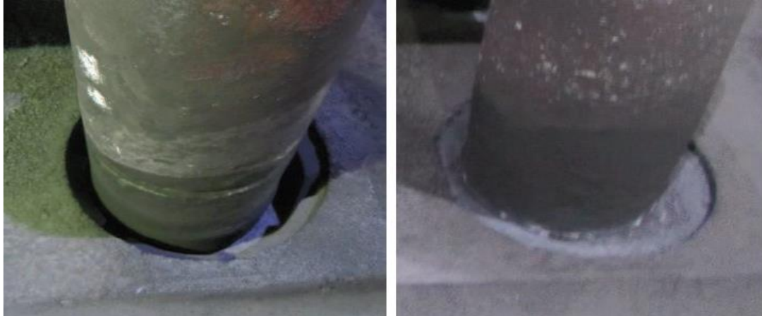
Figure 2-9: Position excentrée du rondin dans le tourillon conduisant à la fonte avec une épaisseur de couronne inégale [19]
