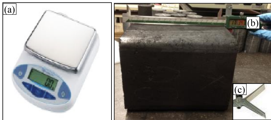
Figure 3. 14 : Instruments pour la mesure de la densité des anodes de laboratoire (a) Balance électronique, (b) Pied à coulisse numérique, (c) Équerre.
