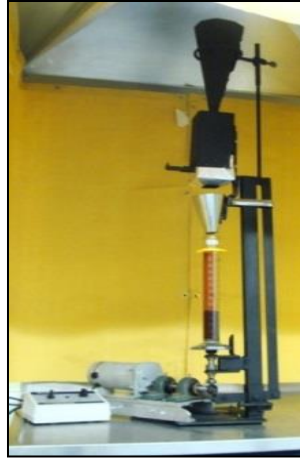
Figure 3. 7: Dispositif de mesure de la densité en vrac.
