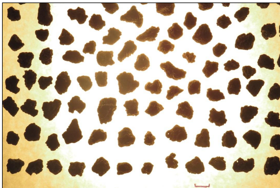
Figure A. 1: Image de particules grosses de CHTS avant traitement par le logiciel Clemex Vision 7.
