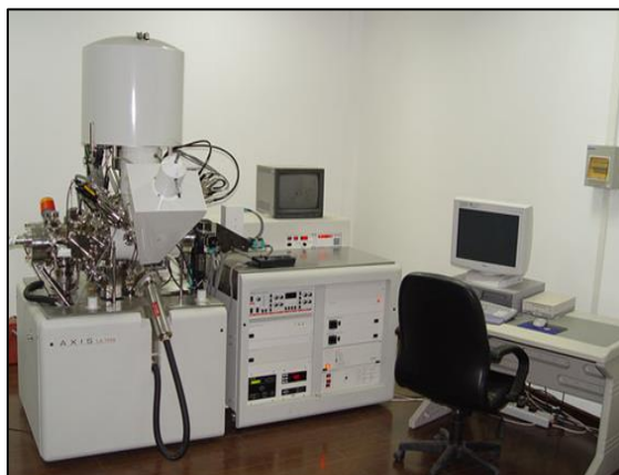
Figure 3. 20 : Équipement de la spectrométrie photoélectrique induit par rayon X de l'Université d'Alberta.
