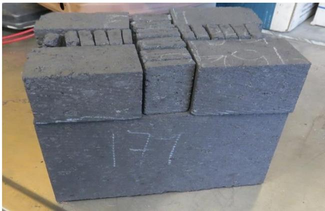
Figure 4-36: Anode découpée vue du côté de la face 1 (grande face)
