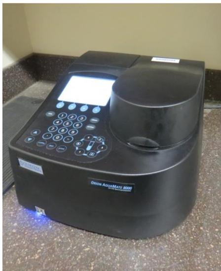
Figure 3-13: Appareil ORION AQUAMATE 8000
