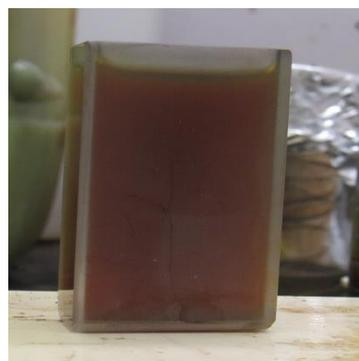
Figure 4-29: Solvant avec du brai pur
