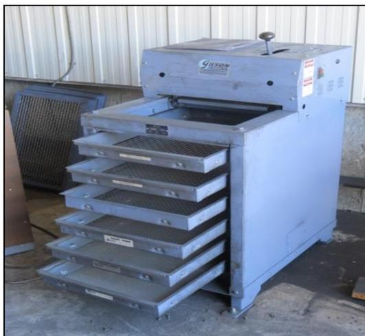
Figure 3-2: Appareil Gilson Testing Screen, modèle TS-1
