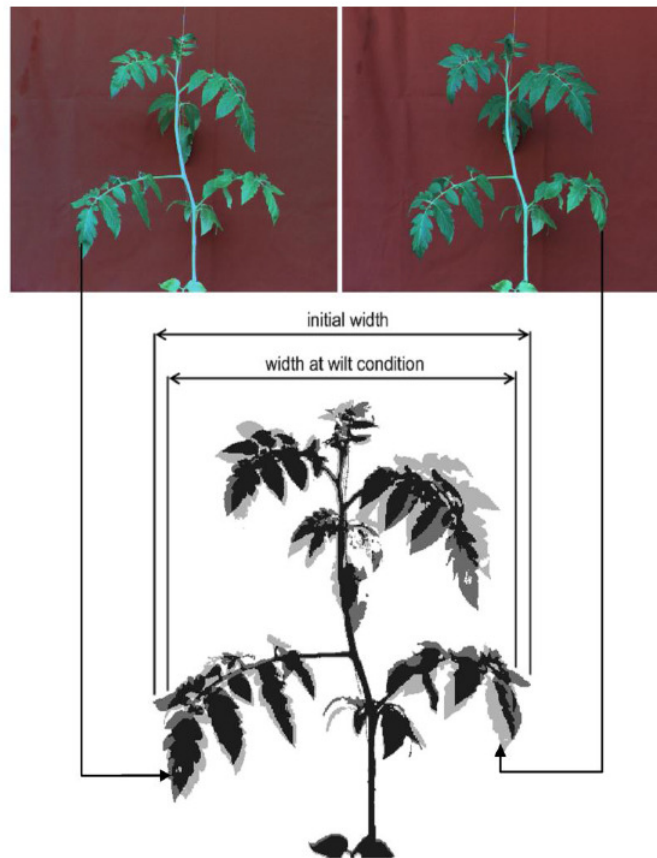
Figure 18 Mesure du flétrissement de l'essai de Ahmad, et al. [29].
