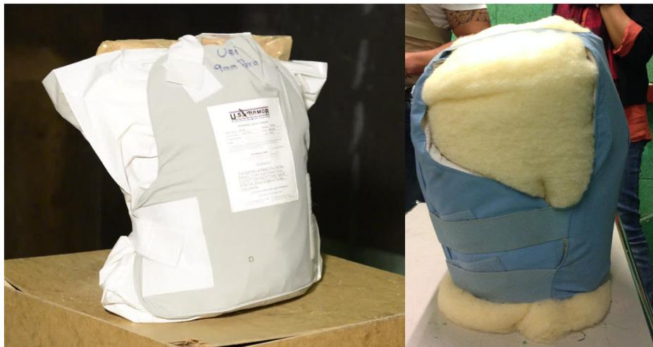
**Figure 9: Gilet avec sac de sable (gauche) et gilet avec de la ouate (droite)**
