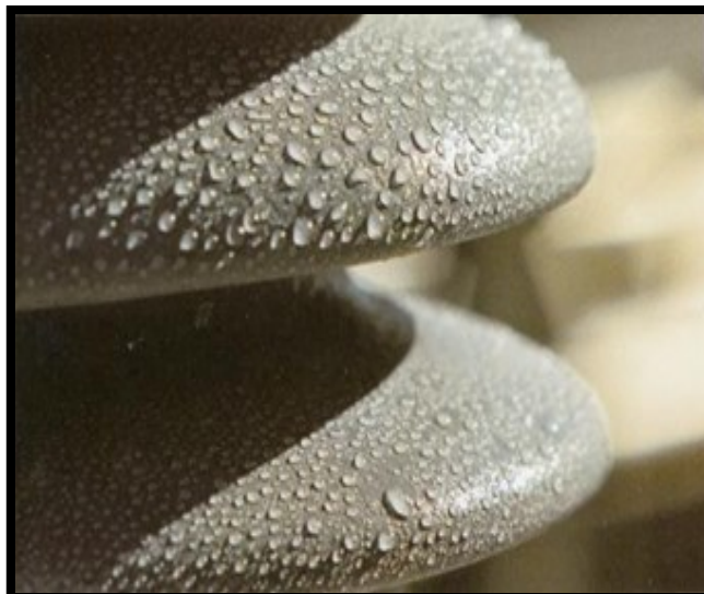
Figure III. 1 : Application du PDMS hydrophobe sur les isolateurs externes de haute tension [109].
