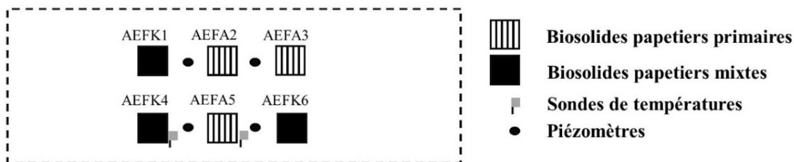
Figure 2 Dispositif d'enfouissement pilote de biosolides papetiers mixtes et de biosolides papetiers primaires répartis de manière aléatoire avec trois répétitions par type de biosolides, pour un total de six unités expérimentales, dont les gaz à effet de serre ont été mesurés au cours des saisons 2013 et 2014 sans couvert nival. Les unités expérimentales AEFK4 et AEFA5 contenaient chacune quatre sondes de température à des profondeurs différentes (-0,1, -0,5, -1,0 et -2,0 m). Quatre piézomètres allant jusqu'à 2,0 m de profondeur étaient installés entre les unités expérimentales.
