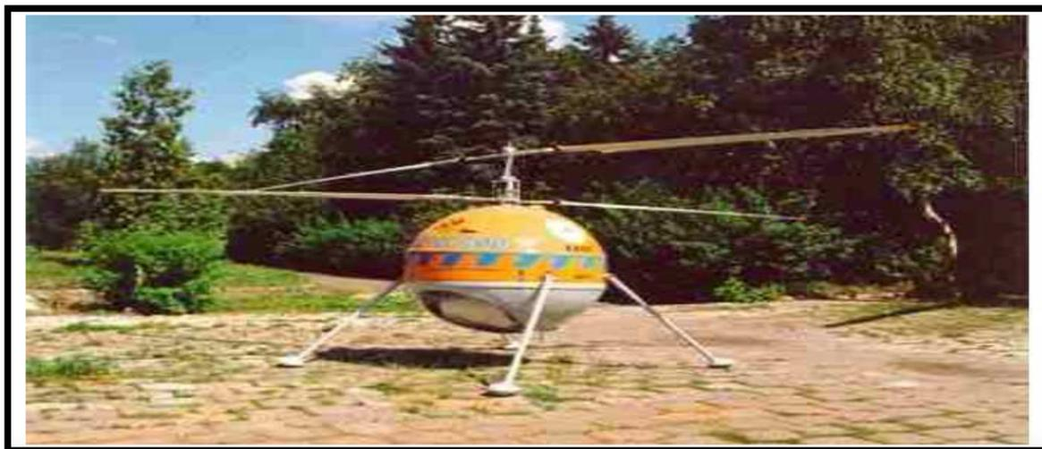
Figure 1.10 Le drone à rotors coaxiaux Ka-137 à usage externe
