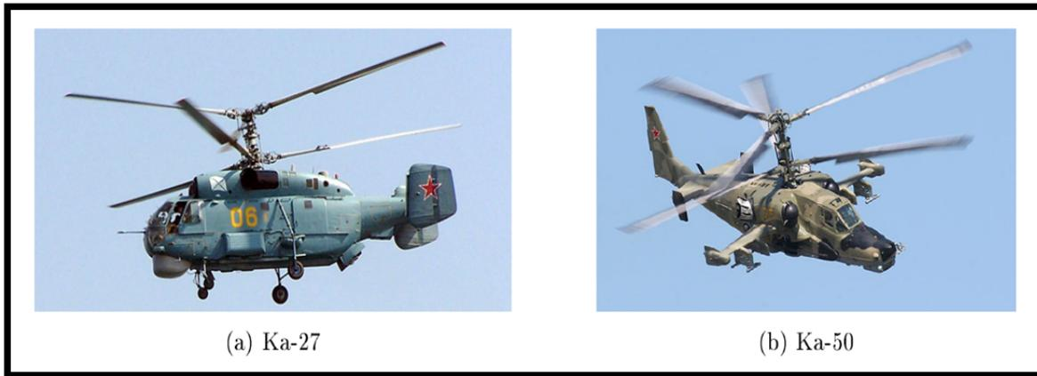
Figure 1.8 Exemple d'hélicoptère à rotors coaxiaux
