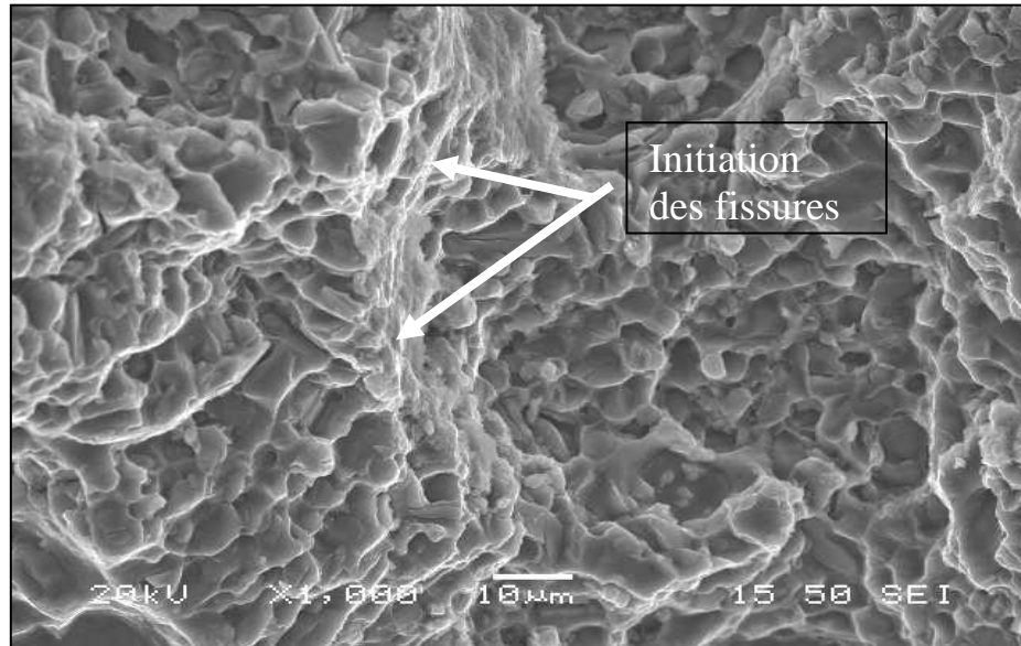
Figure 6.11: Micrographie avec MEB montre le mécanisme de fracture et initiation de fissures de l'alliage A357-T6 semi-solide après test de fatigue.
