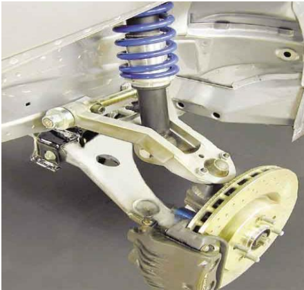
Figure 5.7 : Exemple de bras de suspension installé.
