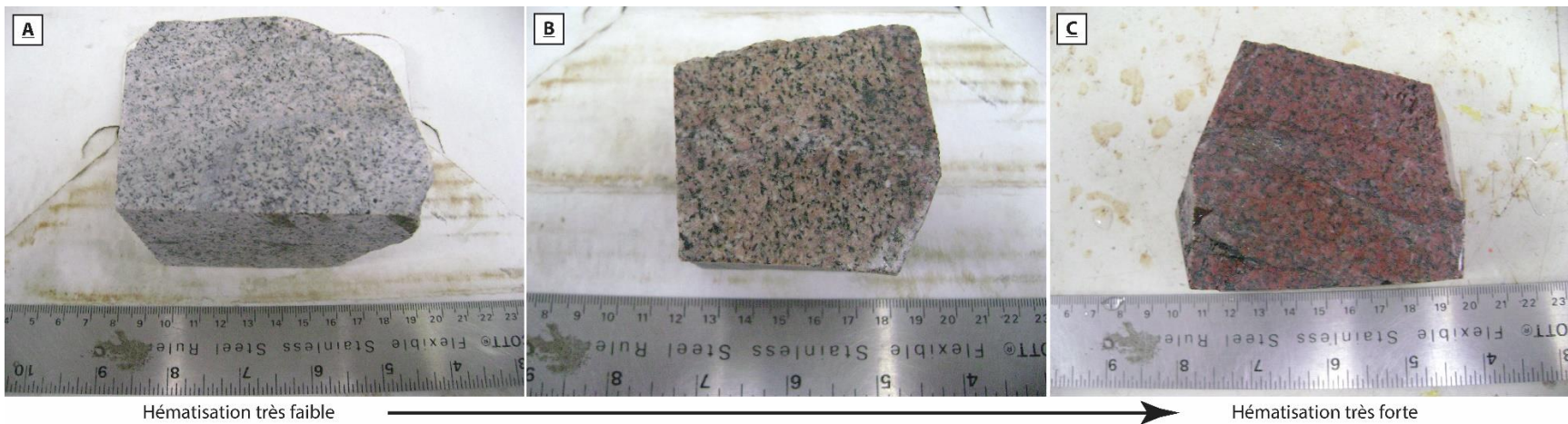
FIGURE 3.2 VARIATION DE L'INTENSITÉ D'HÉMATISATION (A) FAIBLE - ALBITE DOMINANTE; (B) MOYENNE - INTENSITÉ RETROUVÉE GÉNÉRALEMENT DANS L'INTRUSION; (C) TRÈS FORTE - SUPERPOSITION ASSOCIÉE AUX ZONES MINÉRALISÉES
