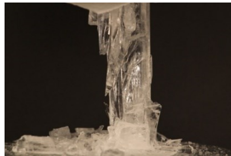
Figure 3-10 : Rupture d'une éprouvette cylindrique après essai de compression uniaxiale (taux de déformation de 10^{-2} \text{ s}^{-1} )
