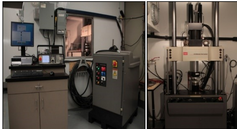
Figure 3-8 : Différentes composantes de la machine de test à boucle fermée MTS 810
