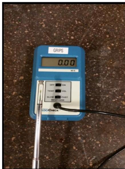
*Figure 3.3 : Anémomètre à fil chaud utilisé pour les mesures au laboratoire*
