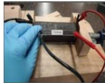
Figure 3-5 : Montage pour la mesure de la résistivité électrique
