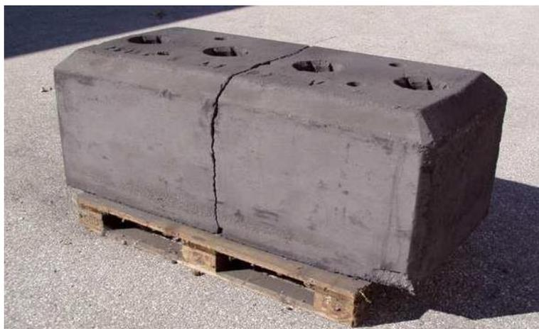
Figure 2-2 : Anode fissurée due à une libération des contraintes pendant l'étape de préchauffage [24]
