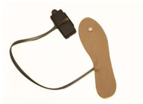
Figure 7.b: Représentation de la semelle instrumentée
