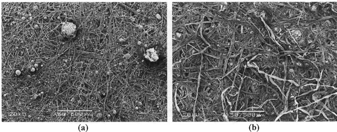
**Figure 26** : Mauvaise dispersion des particules SrTiO<sub>3</sub> dans le cas du (a) Jonc (38.4%) et (b) Kraft (33.2%) ; grossissement x50.
