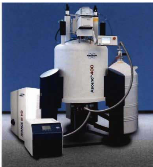
Figure 3-4 Spectromètre RMN Bruker AVANCE III 400 utilisé pour l'acquisition des spectres RMN du ^{31}\text{P}
