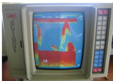
Figure 27 - Equipement de navigation : le sondeur (Kherraz et al, 2006).
