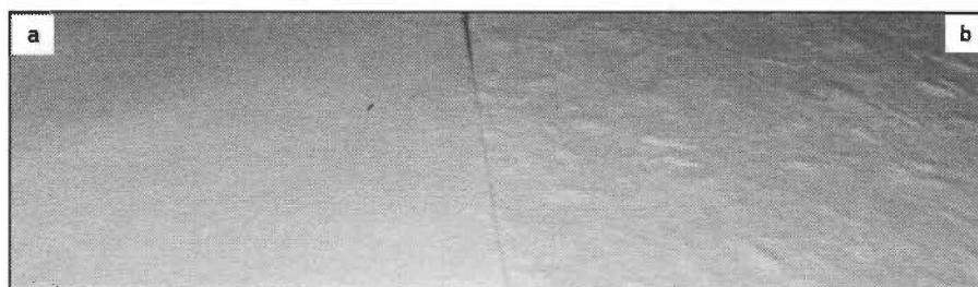
Figure III.45 Images d'une feuille de papier à base de fibres de Kraft acylées (a) et acétylées (70% en masse) (b).
