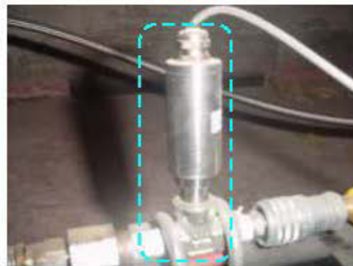
Figure A.II.5: Le capteur de pression utilisé dans l'expérimentation
