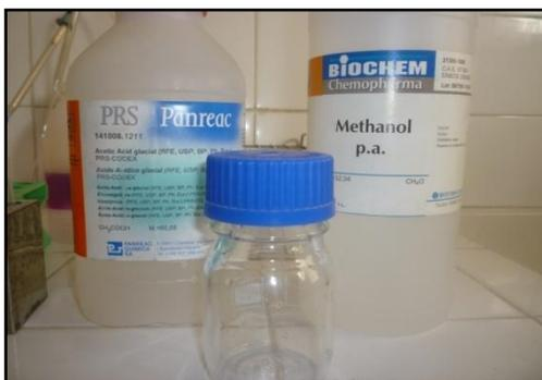
**Figure 51 :** Préparation de la solution de Carnoy : 1 volume d'acide acétique/3volumes de méthanol
