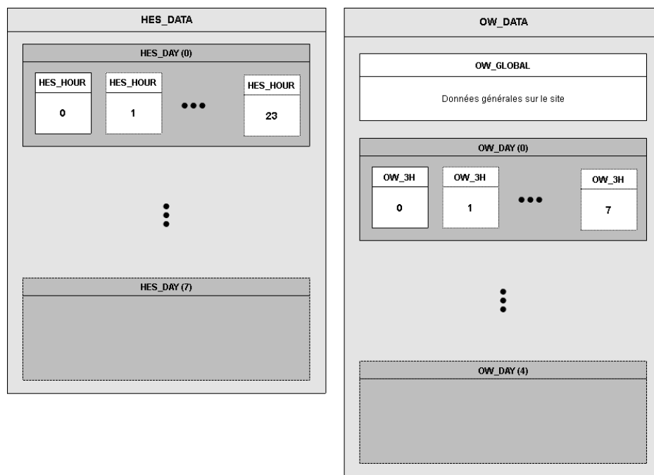
Figure 29 - Comparatif des structures des types de données (Gauche : HES / Droite : OpenWeatherMap)
