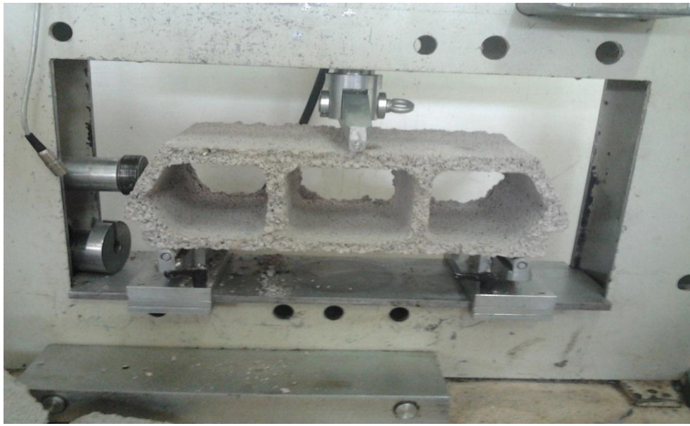
Figure III.10: l'essai de traction par flexion sur la machine didactique universelle (Premier et troisième échantillon).
