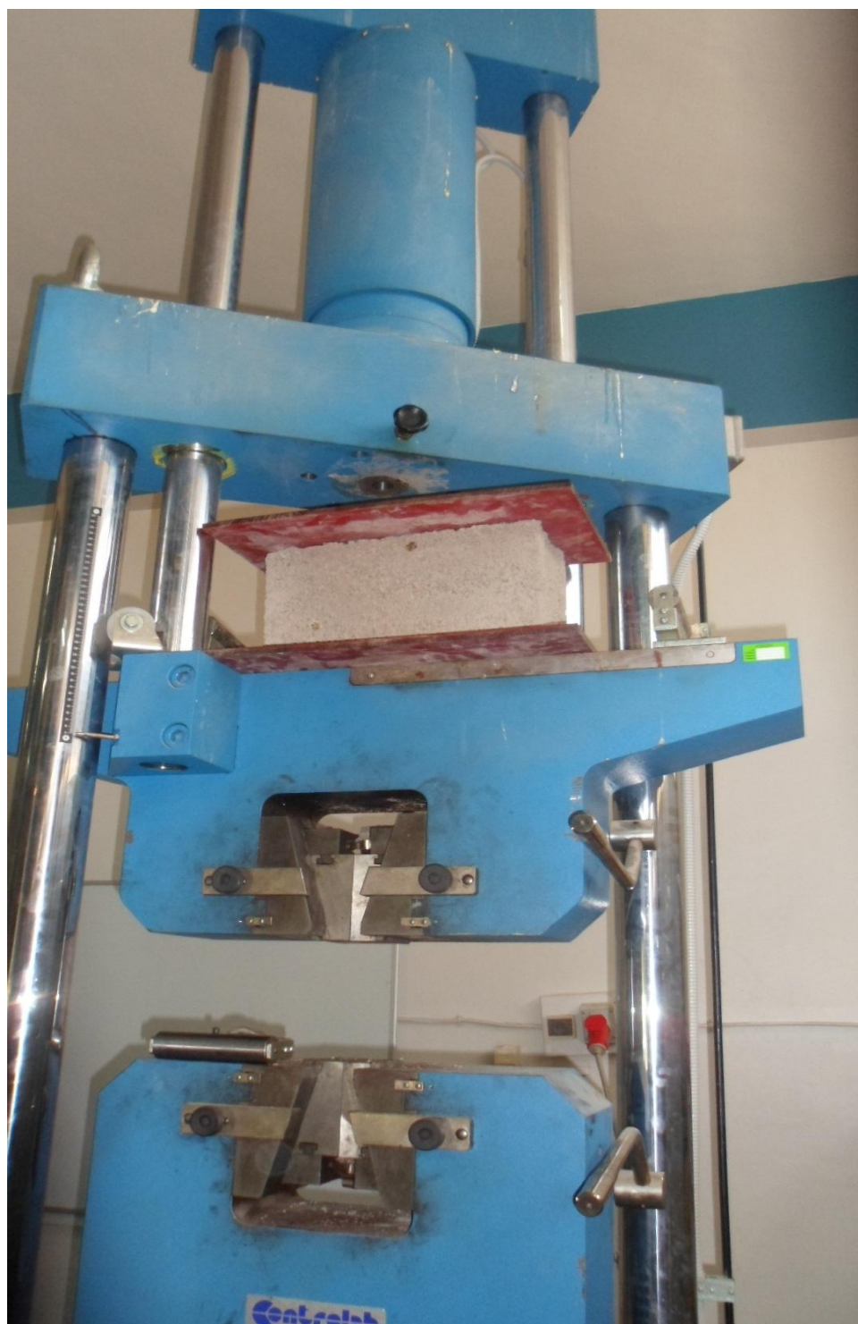
Figure III-9:l'essai d'écrasement sur la machine universelle traction Compression 600 KN pour Le deuxième échantillon.
