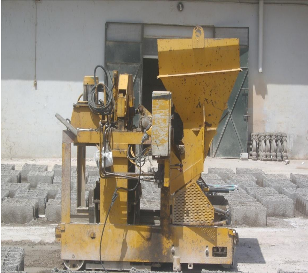
Figure I.10: Machine mobile « Pondeuse » plate-forme Chetouane.
