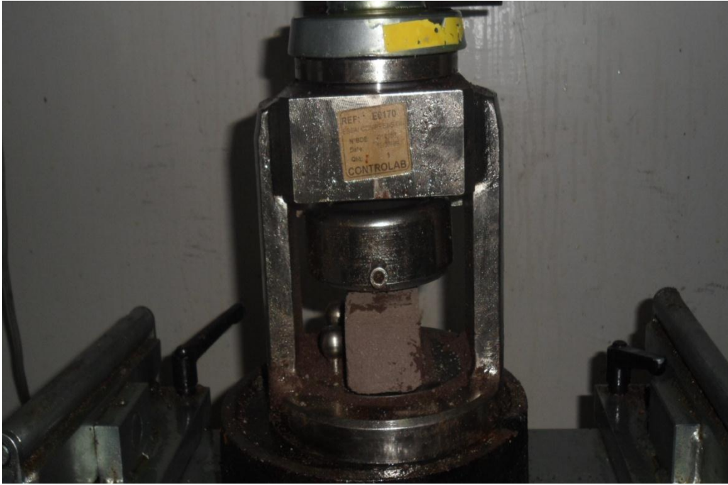
Figure II- 5 : essais de compression sur la machine didactique universelle
