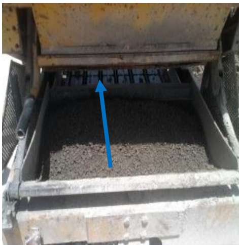
Figure : III.5: compactage sous vibration au moment du remplissage des moules.
