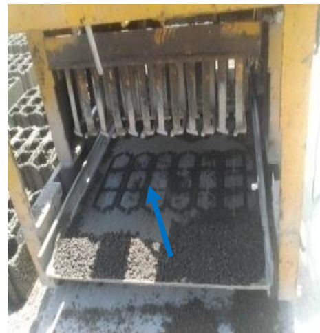
Figure : III.5: compactage sous vibration au moment du remplissage des moules.
