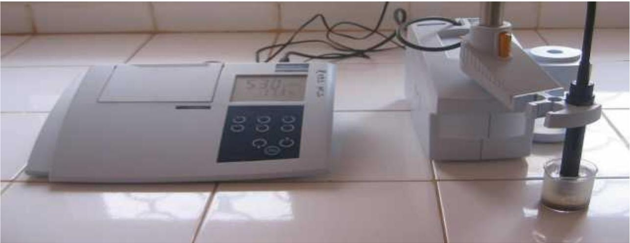
**Figure 36 :Conductimètre**
