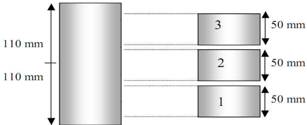
Figure IV.1 : Extraction des disques d'une éprouvette [DJE 2007].
