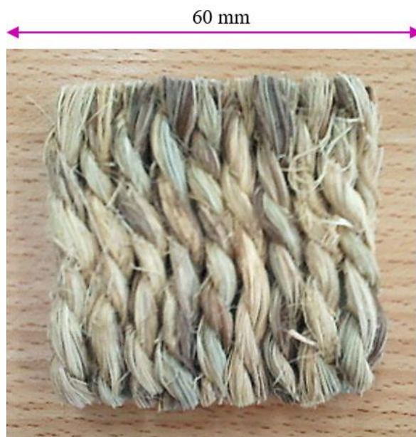
Figure 3.10 Photo type des fibres d'alfa tissées collées sur le support de cisaillement
