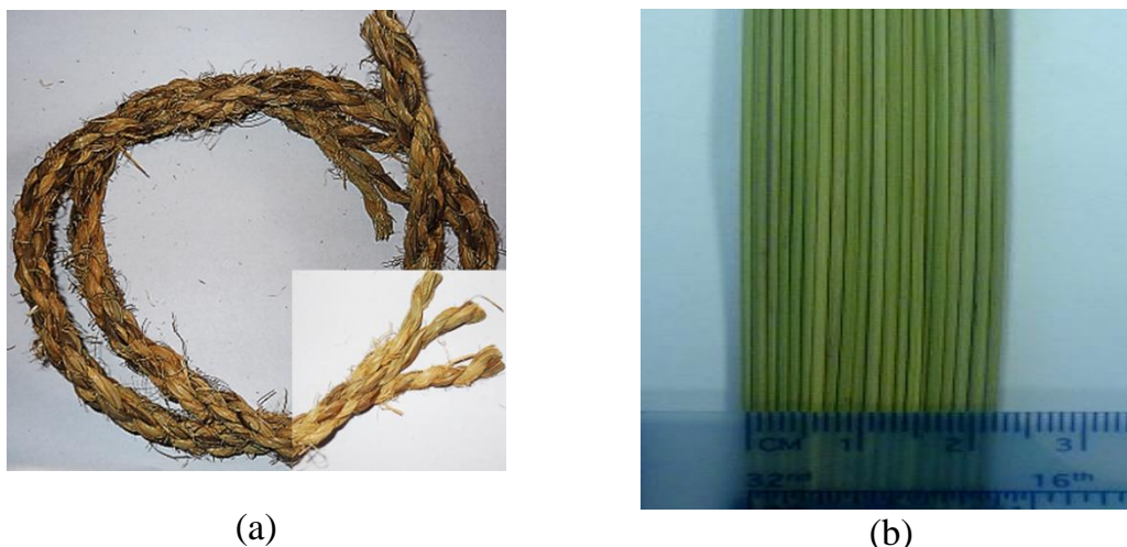
Figure 3.2 Types d'Alfa utilisés : (a) fibres extraites et tissées ; (b) feuilles naturelles
