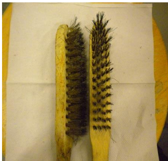
Figure 2. 2 Brosses métalliques utilisées pour le peignage
