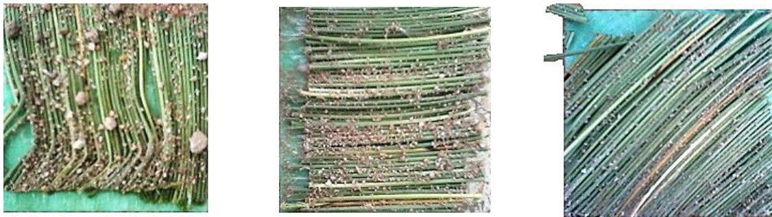
Figure 3.13 Décollement des feuilles d'Alfa après l'essai du cisaillement
