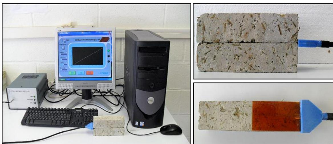
**Figure 3.15 :** FP2C Conductivimètre Fil Chaud – Neotim (Laboratoire PRISME, Polytech'Orléans, Université d'Orléans, France)
