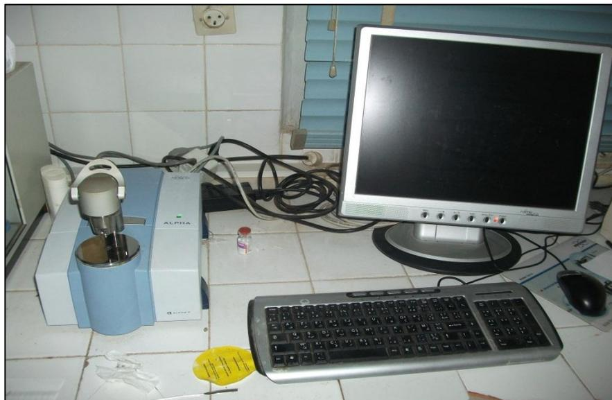
**Figure 3.7 :** Spectromètre infrarouge ALPHA Bruker (Laboratoire de Chimie Des Polymères-LCP- Université d'Oran, Algérie).
