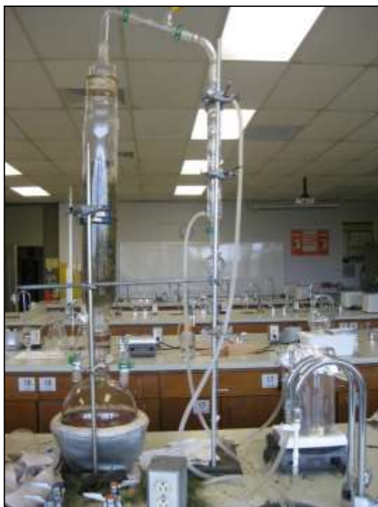
Figure 6. Système d'extraction des huiles essentielles par entraînement à la vapeur
