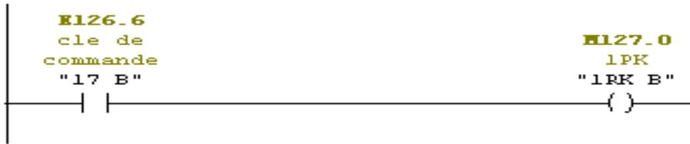
Figure 39: Schéma à contacts de démarrage de la pompe
