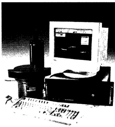
Photo 4 : Composants matériels du sonar : tête du récepteur, tête émettrice auxiliaire et ordinateur de calcul
