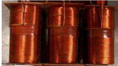
**Figure 2.2 :** Conducteurs en cuivre émaillé de diamètre rond
