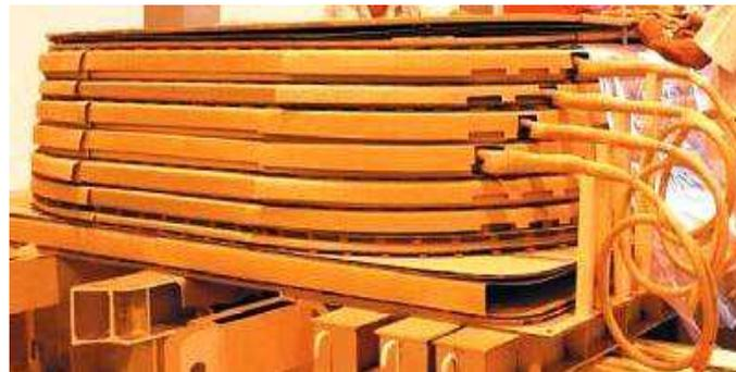
**Figure 2.3 :** Conducteurs en aluminium de forme méplat
