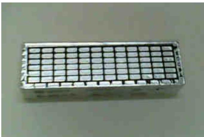
**Figure N°6** : Bac de développement recouvert d'un film d'aluminium et contenant tous les réactifs nécessaires à la réalisation du test.
