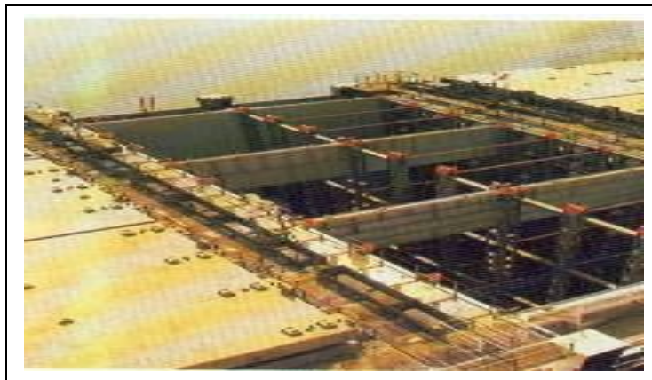
Figure n°6: Vu plongeant de la cale d'un navire porte-conteneurs montrant les glissières facilitant l'empilement et la mise en places des conteneurs
