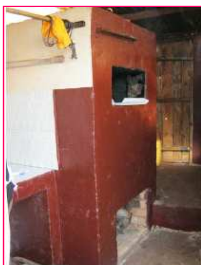
Figure 3: Fumoir en brique de la Charcuterie Zazah Ivandry (Auteur)
