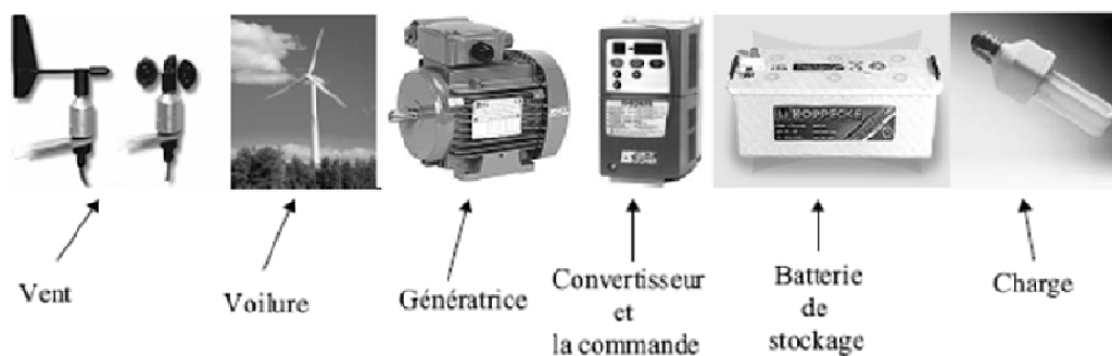
Fig.2.1 Chaîne de conversion de l'énergie éolienne.
