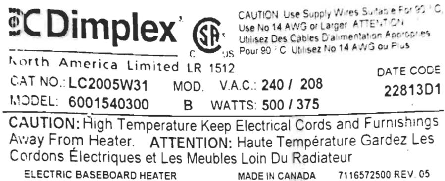
Figure 3-8 : Plaque signalétique de la plinthe électrique utilisée dans ce travail
