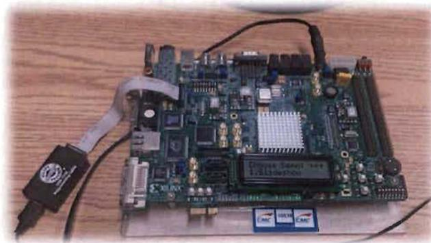
Figure 4-12 : La carte d'évaluation FPGA Virtex-5 XC5VLX110T de Xilinx
