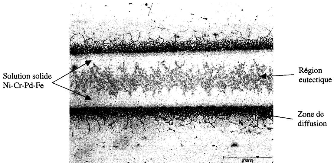
Figure 50 Microstructure type près du centre d'un joint brasé avec l'alliage CPW 475 suite à un brasage prolongé de 60 min.
