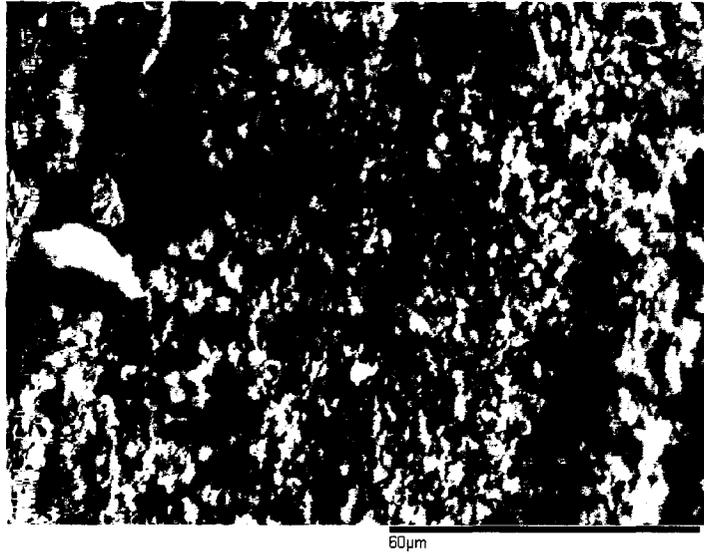
Figure 32 Essai avec bille 52100 plaque 316L, force = 0.72N, amplitude = 100µm, sans courant
