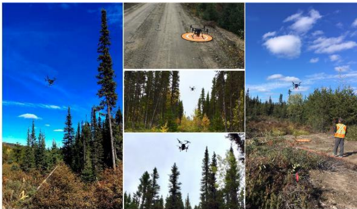
Figure 1.5. Survol expérimental par drone pour la création de l'indice de végétation des peuplements. Janie Lavoie, octobre 2018
