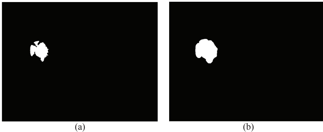
Figure.II.11 : Effet de dilatation. a) Image initiale ; b) Image dilatée.
