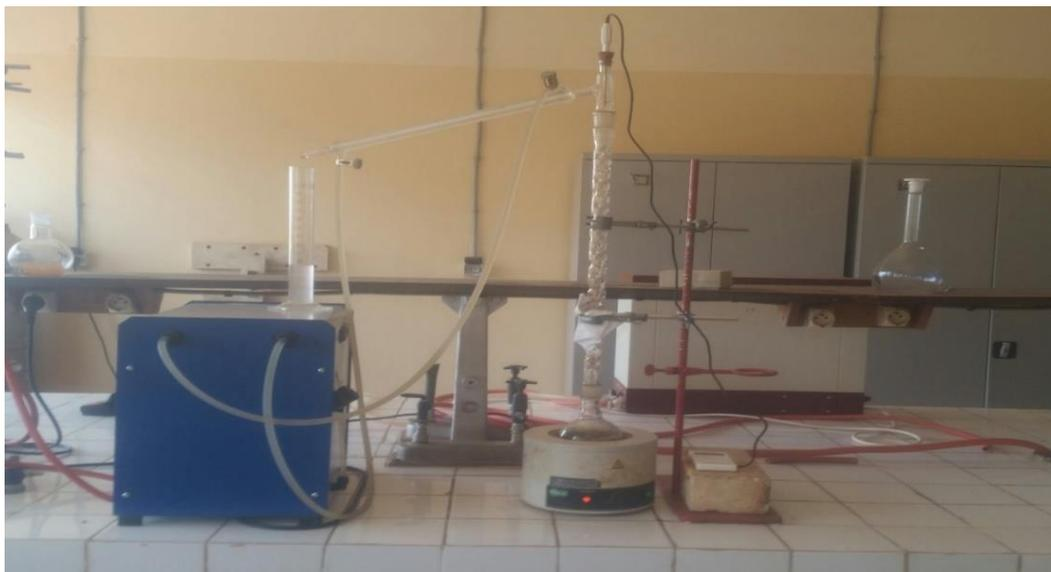
Figure 7: Montage expérimentale de l'hydrodistillation des huiles essentielles d'Eucalyptus
