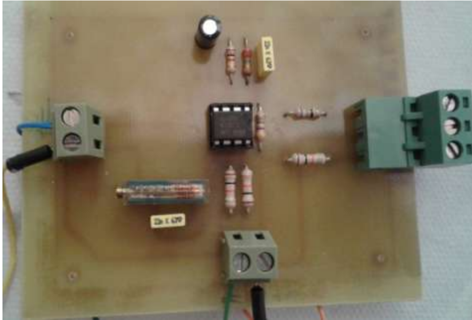
Figure III.24 : Circuit réalisé de mise en forme du signal PPG.
