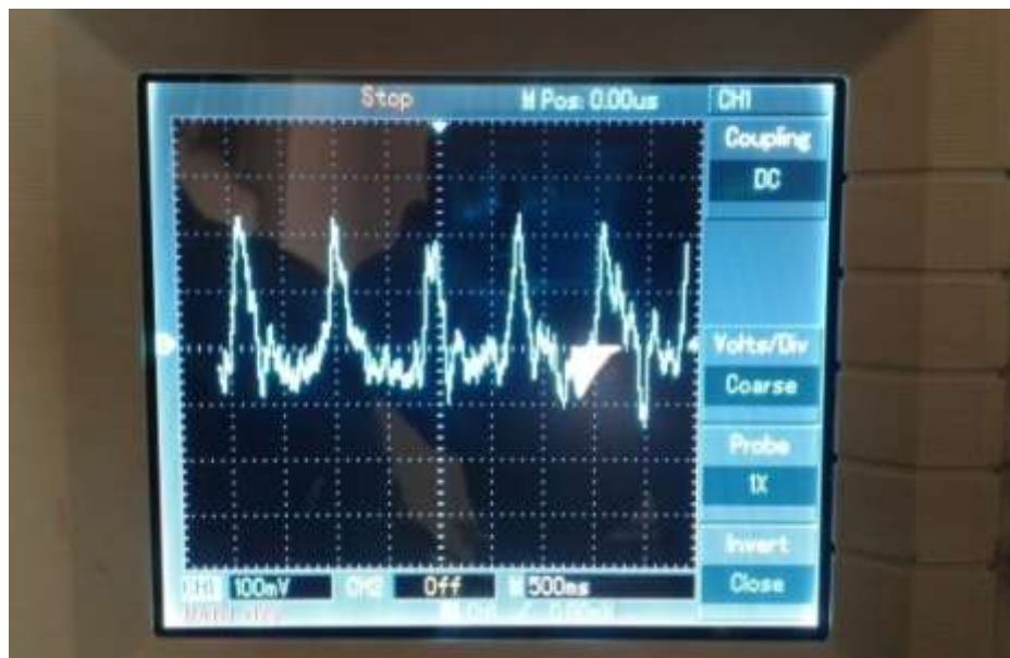
Figure III.23: Tracé du signal PPG visualisé sur oscilloscope.
