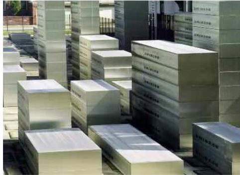
Figure 2-17: Dalles d'aluminium avant laminage [56].
