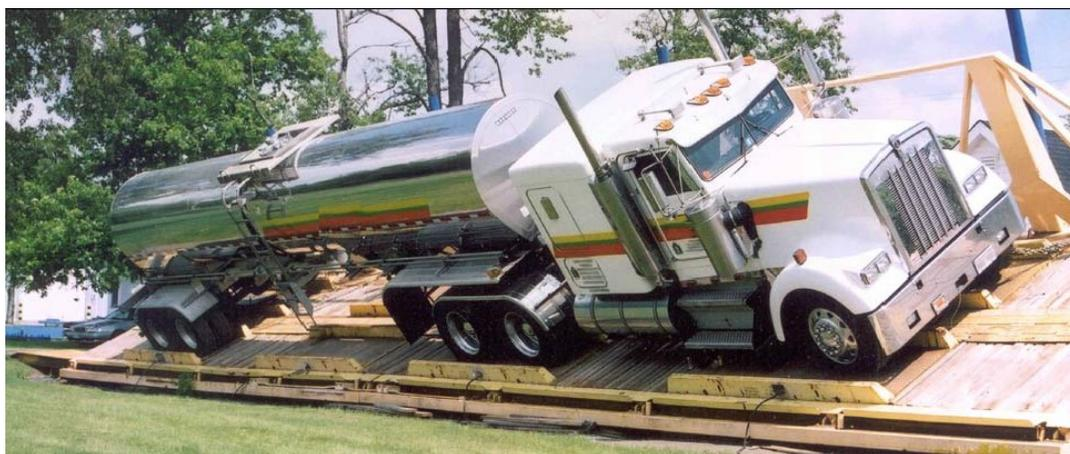
Figure 2-1: Table d'inclinaison pour véhicules lourds [12].
