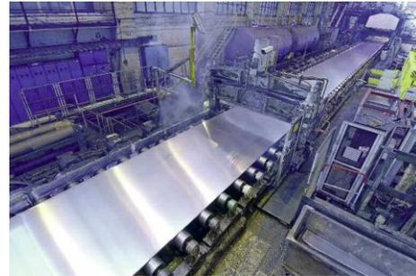
Figure 2-18: Train de laminage [56].
