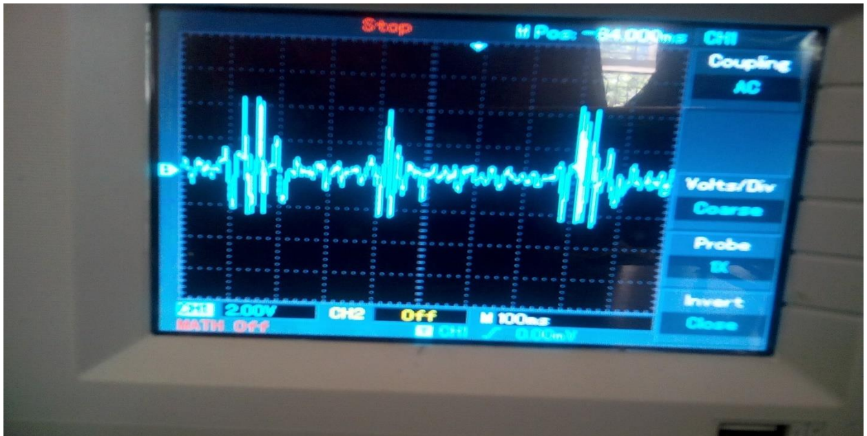
Figure 3.39 : Signal PCG à la sortie du circuit de mise en forme
