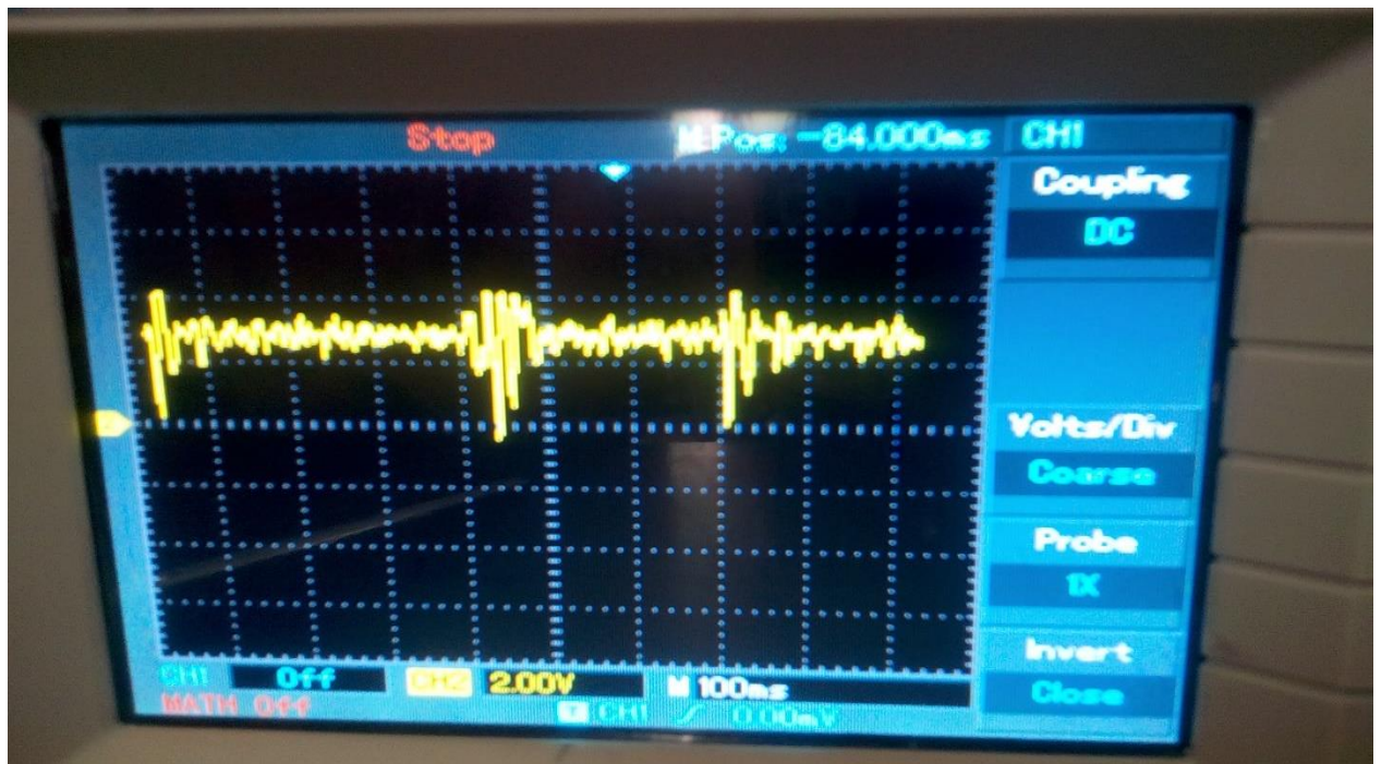
Figure 3.45 : Signal PCG à la sortie du circuit d'offset
