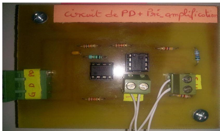
Figure 3.9 : Réalisation du circuit de préamplificateur et de l'électrode du pied droit
