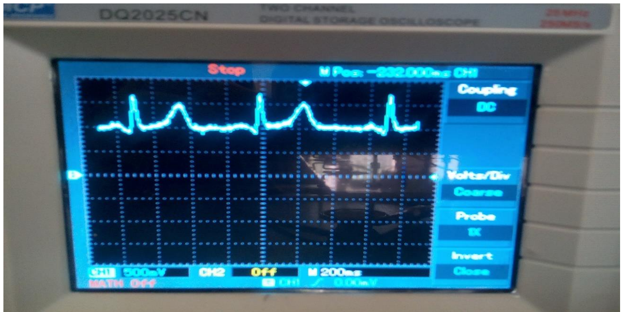
Figure 3.44 : Signal ECG à la sortie du circuit d'offset
