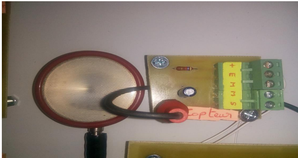
Figure3.29 : réalisation du circuit de microphone
