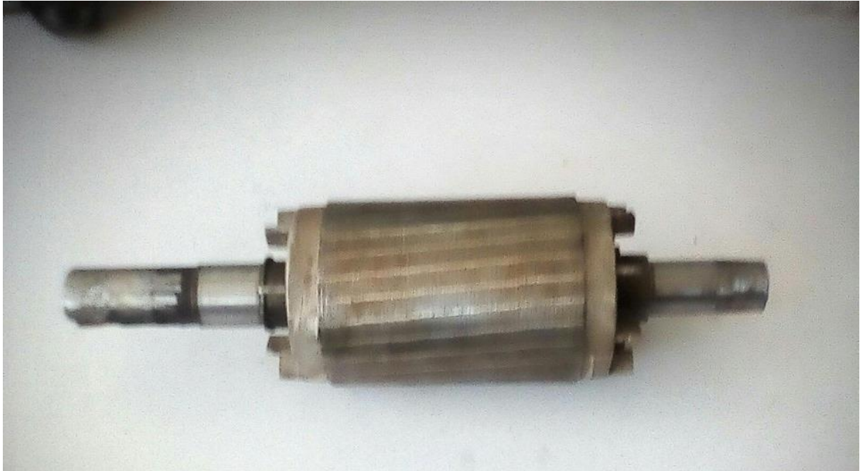
Figure 4. 5: Le rotor magnétique.
