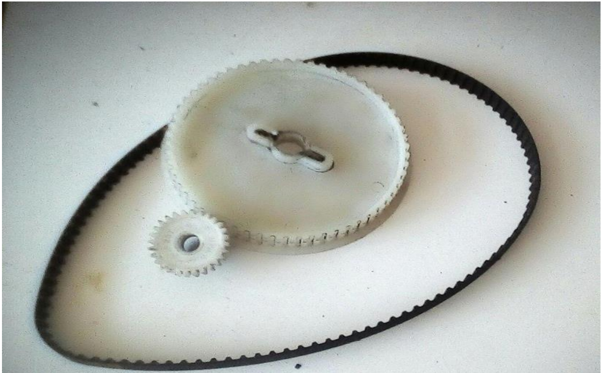
Figure 4. 3: Engrenages et courroie.
